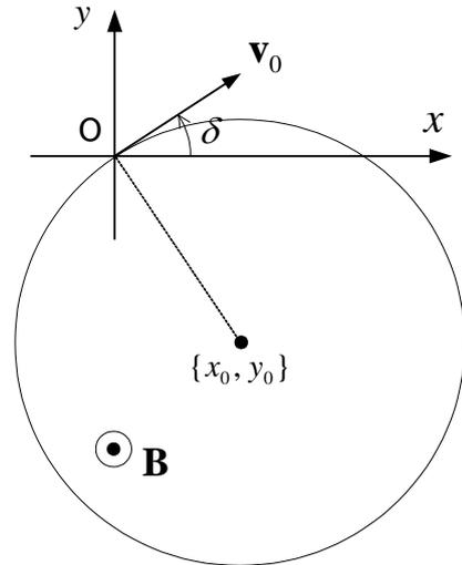
図2 ローレンツ力による荷電粒子の運動の軌跡
