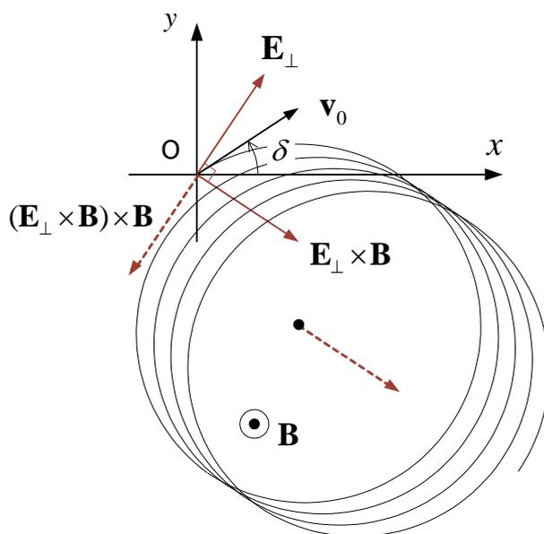
図 3 クーロン力とローレンツ力が作用するときの荷電粒子の軌跡
